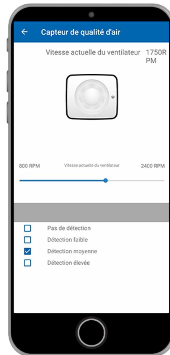
12. Sélectionner la fonction cycle automatique
