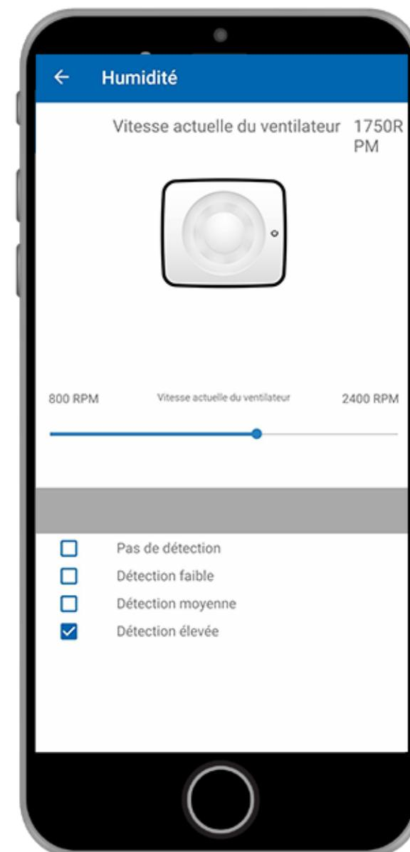
9. Sélectionnez la fonction de vitesse constante
