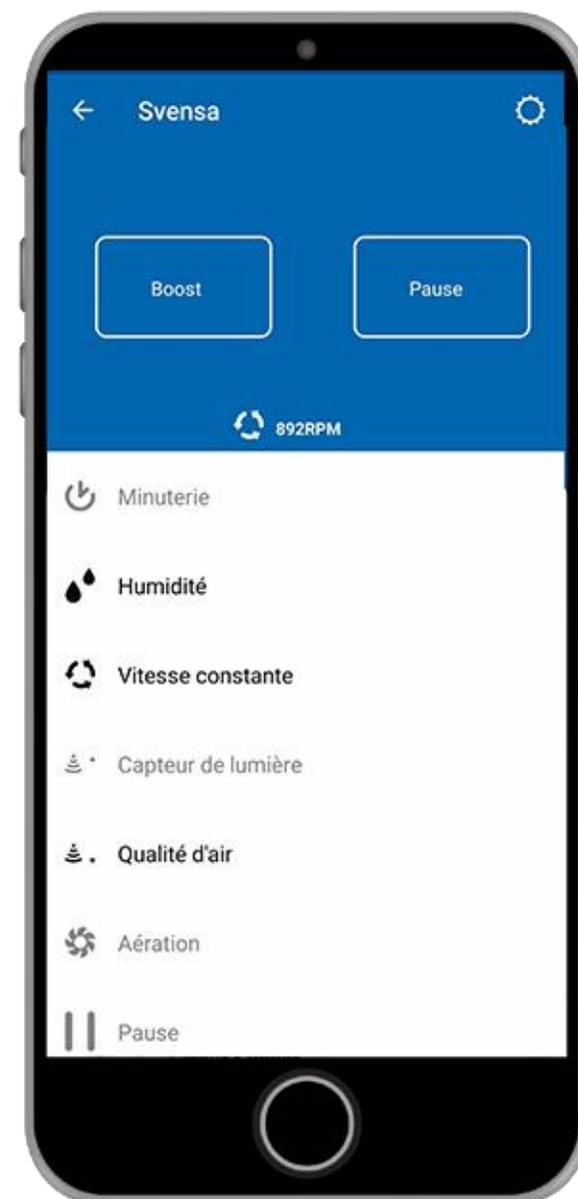
7. Sélectionnez la case de la minuterie ⏴ dans le menu de fonctions pour régler la vitesse du ventilateur entre 800 et 2400 tr/min, pour régler le temps de fonctionnement et pour régler la temporisation au démarrage.
