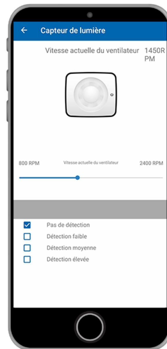
11. Sélectionnez la fonction de qualité de l'air
