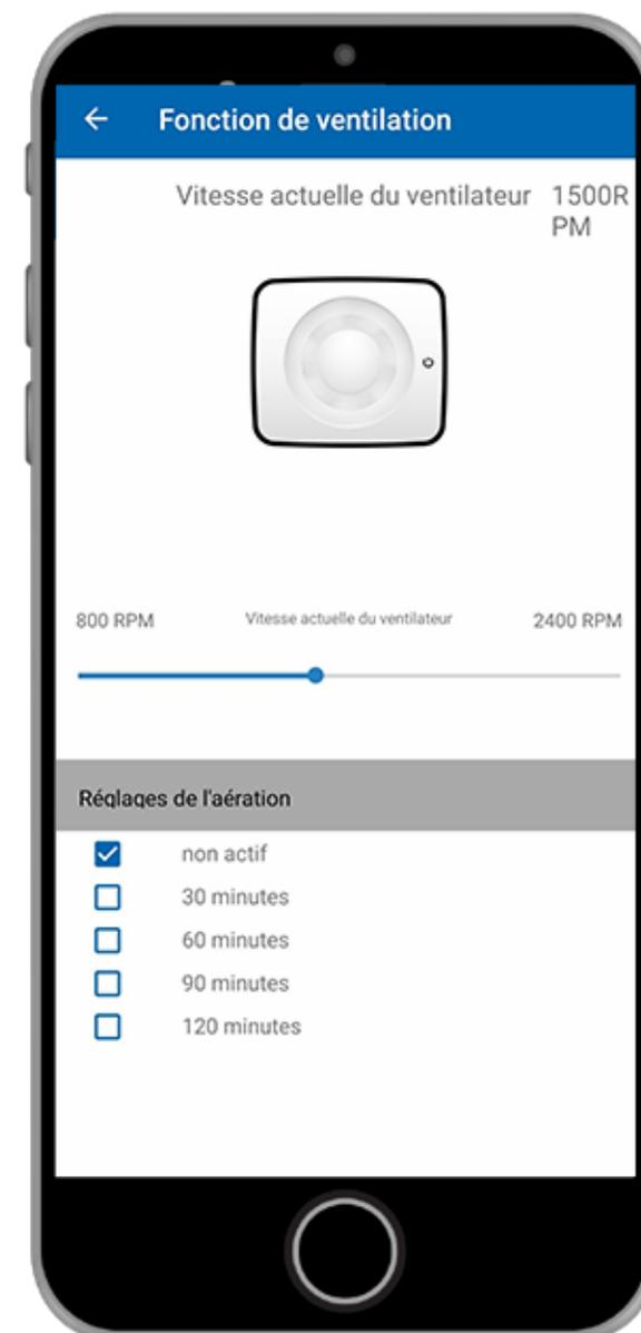
13. Vous pouvez également sélectionner la fonction pause **||** au bas du menu de fonction pour régler les paramètres de pause, de 30 minutes à 120 minutes.
